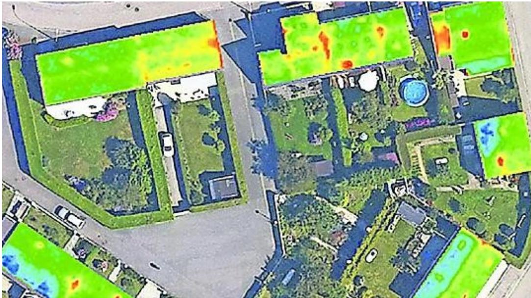
In der Maschine der Firma Eurosense ist eine hoch auflösende Wärmebildkamera eingebaut, die alle Dachflächen fotografiert. FOTO: Stadt Meerbusch
